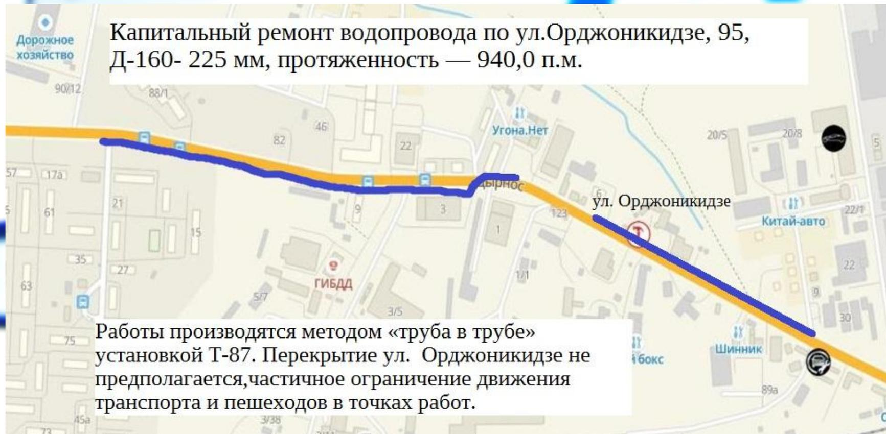
Работы производятся методом «труба в трубе» установкой Т-87. Перекрытие ул. Орджоникидзе не предполагается, частичное ограничение движения транспорта и пешеходов в точках работ.
