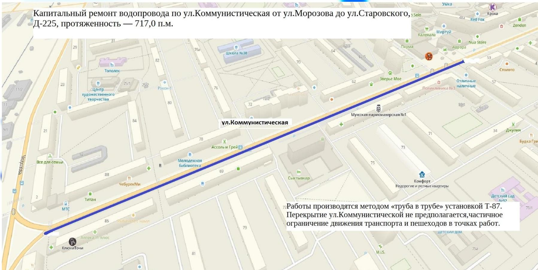
Работы производятся методом «труба в трубе» установкой Т-87. Перекрытие ул.Коммунистической не предполагается,частичное ограничение движения транспорта и пешеходов в точках работ.
