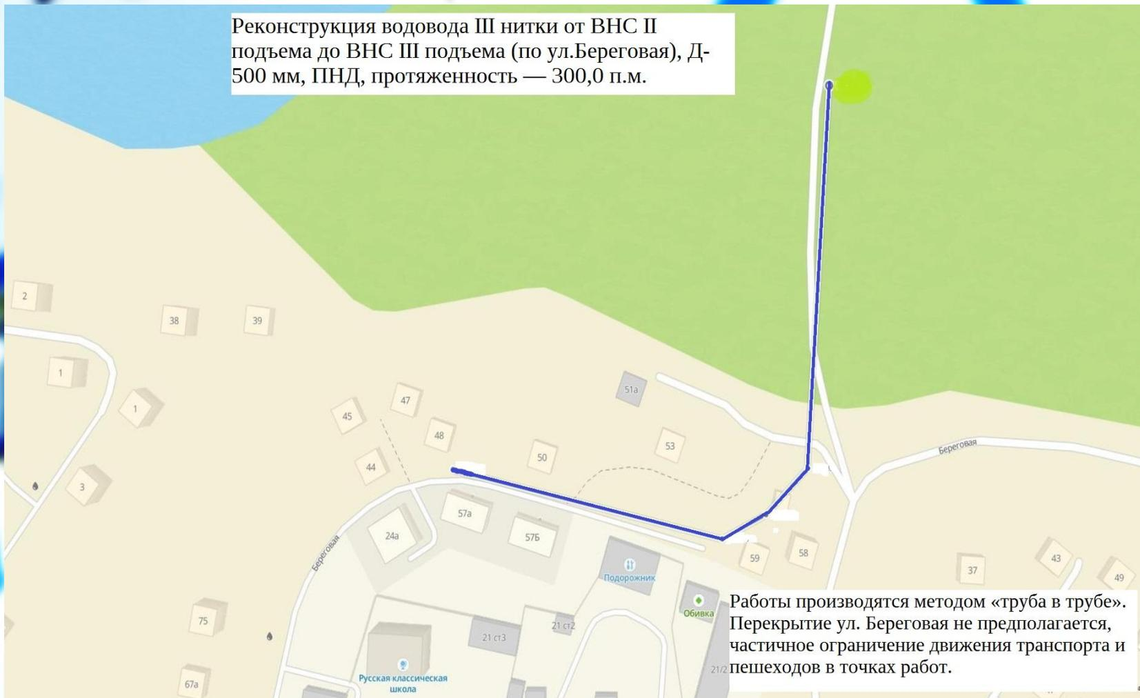
Работы производятся методом «труба в трубе». Перекрывание ул. Береговая не предполагается, частичное ограничение движения транспорта и пешеходов в точках работ.
