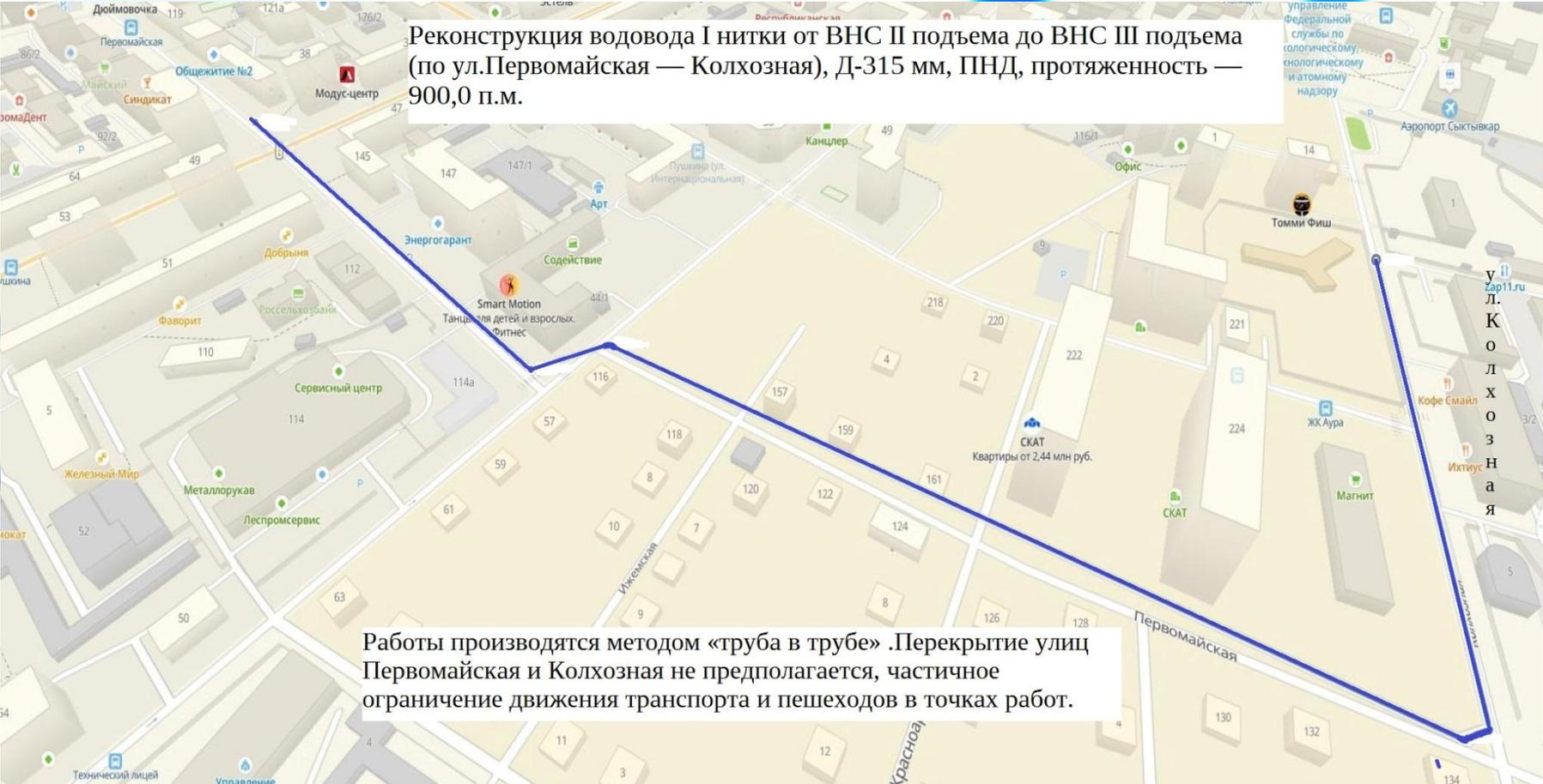
Реконструкция водовода I нитки от ВНС II подъема до ВНС III подъема (по ул.Первомайская — Колхозная), Д-315 мм, ПНД, протяженность — 900,0 п.м.
